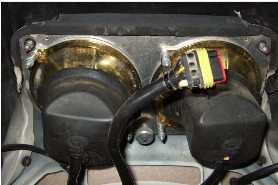
Zur Vermeidung von Streulicht in der Verkleidung, befindet sich bei der 900ie ein Schaumstoffstreifen auf der Oberkante des originalen Scheinwerfers. Um diesen am neuen Scheinwerfer befestigen zu können, kann ein ca. 240 mm langes Alu-Winkelprofil 10x10x1 von vorn mit 3 Schrauben M5x5 längs der Oberkante der Platte angeschraubt werden.
