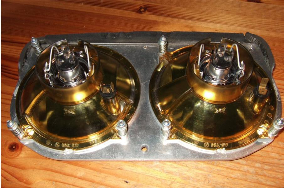
Ist eine Befestigungsnase geplatzt, können die Scheinwerfereinsätze mit säurefreiem Silikon von hinten in die Platte eingeklebt werden. Zum Zentrieren den Scheinwerfereinsatz mit drei Schrauben fixieren, bis das Silikon abgebonden hat.
